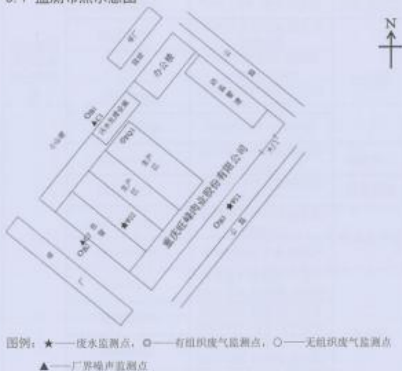
图 1 废水、有组织废气、无组织废气和厂界噪声监测布点示意图
