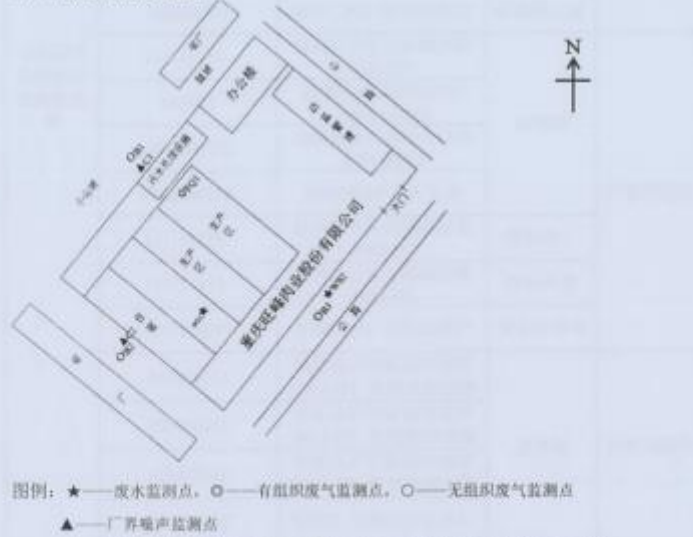
图 1 废水、有组织废气、无组织废气和厂界噪声监测布点示意图
